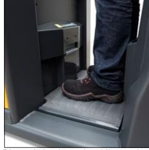
Bireysel olarak ayarlanabilen yaylı konforlu durma platformu (opsi- yonel)
