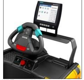
WMT 110 veri frekans terminalli opsiyonel askı (opsiyonel)
