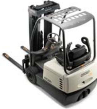
SC 4200 Serisi 3 Tekerlekli Forklift Yük Kapasitesi: 1250, 1600 ve 1800 kg Kaldırma Yüksekliği: 2890 - 7495 mm
